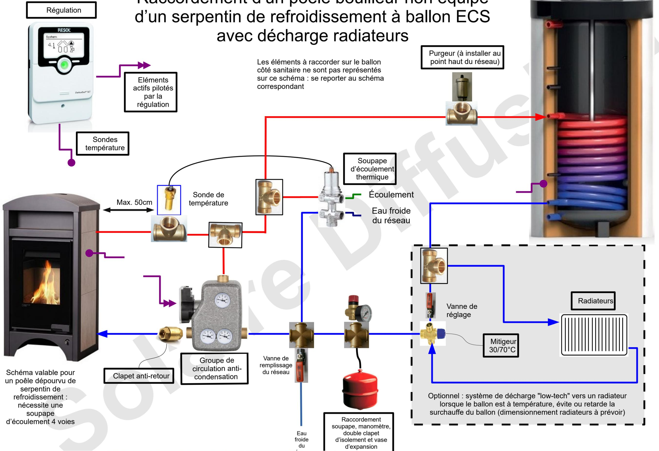
Schéma valable pour un poêle dépourvu de serpentin de refroidissement : nécessite une soupape d'écoulement 4 voies
